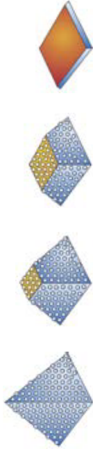
Abschleifverhalten der Pyramidenstruktur
