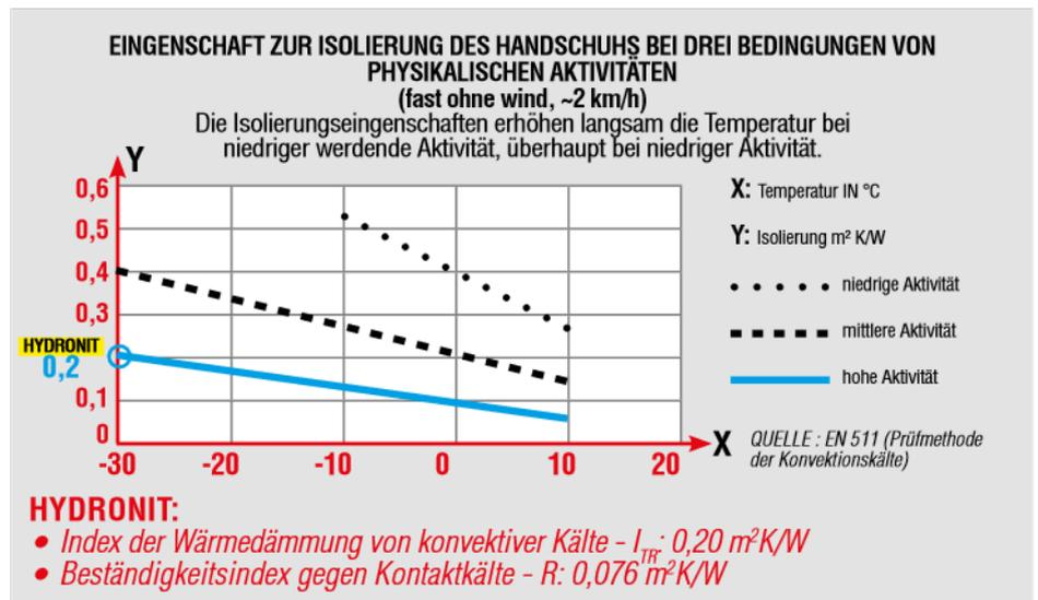
Der Handschuh HYDRONIT gewährleistet Schutz bei Arbeiten bis -30°C. Bei anderen Handschuhen mit dem gleichen Index reduzieren sich die Schutzleistungen bei starken Winden und feuchten Bedingungen.
