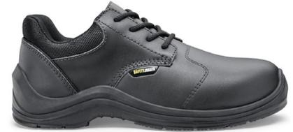
**Beschreibung:** Lederschuh, wasserabweisend, schwarz, Mesh Futter, antistatisch, Anti-Schock, Anti-Rutsch, Durchtrittssichere Stahlsohle, S3, Stahlkappe, PU/Gummi-Sohle.
