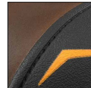
GÜK mit versenkten Nähten
